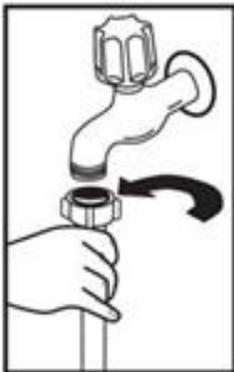
Schließen Sie den Zulaufschlauch direkt an einen Wasserhahn an. Der Wasserdruck in der Versorgungsanlage sollte mindestens 0,03 MPa und maximal 1 MPa betragen. Wenn der Wasserdruck 1 MPa übersteigt, muss vor dem Geschirrspüler ein Druckminderventil eingebaut werden. Nach dem Anschließen öffnen Sie ganz das Ventil und überprüfen Sie die Dichtheit des Anschlusses. Schließen Sie aus Sicherheitsgründen nach jedem Spülvorgang den Wasserhahn.
