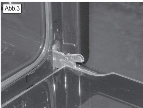
4. Zum Wiederanbringen der FullClear-Backraumtür die Scharniere wieder in ihre Halterungen einführen und sicherstellen, dass sie korrekt positioniert sind.
