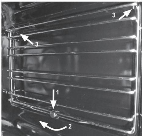
Zum Einhängen zunächst die beiden oberen Haken in die beiden Löcher der Backraumwand einhängen. Dann die unterste Sprosse nach unten über den Haltebolzen hinweg drücken.
