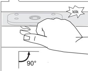
Schieben Sie die Verriegelung mit dem Daumen nach rechts um 90°, bis ein Klick ertönt. Die Türverriegelung ist deaktiviert.
