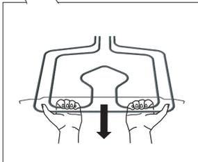
Ziehen Sie das Heizelement so lange, bis sich die Querstange entriegelt ist und aus den Halterungen auf der linken und rechten Seite des Garraums herauspringt.
