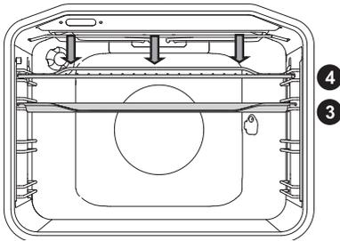
Beim **Großflächengrill** sind das obere Heizelement und das Infrarot-Heizelement, das auf der Garraumdecke befestigt ist, in Betrieb.
