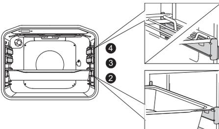
Ziehen Sie bei Teleskop-Ausziehführungen zuerst die Führung einer Einschubebene heraus und stellen Sie den Rost oder das Backblech darauf, schieben Sie danach die Führungen bis zum Einschlag ein.
