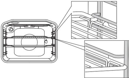
Bei Drahtführungen müssen Sie den Rost und die Backbleche immer in die Führungsrinne der Drahtführungen einschieben.
