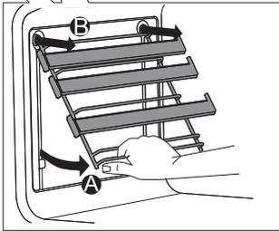
**A** Fassen Sie die Führungen an der Unterseite an und ziehen Sie sie gegen die Mitte des Garraums.
