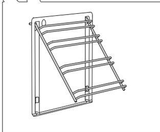
Entfernen Sie die Draht- bzw. Ausziehführungen.
