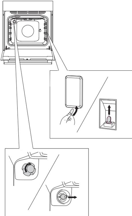
Heben Sie die Abdeckung der Garraumleuchte mit dem Schraubenzieher an und entfernen Sie sie. Nehmen Sie die Glühbirne heraus.
