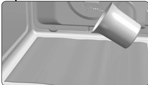
2. Versare lentamente 200 ml di acqua nella parte inferiore della cavità del forno.
