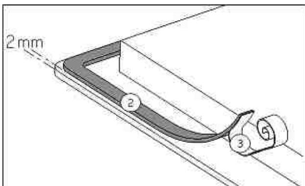
Die Dichtung (2) nach Abnehmen der Schutzfolie (3) mit 2 mm Abstand der Außenkannte des Glases aufkleben.
